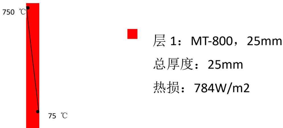
图 7. 用 MT-800 纳米微孔绝热板后在相似能耗情况下，玻璃加工窑壁厚度下降，窑炉内部空间加大
